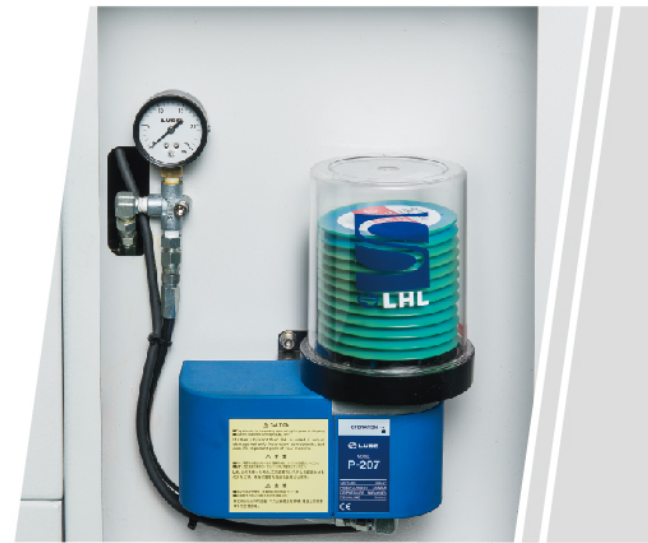
搭配黃油潤滑系統，減少潤滑油使用量80%，並降低切削水更換頻率
