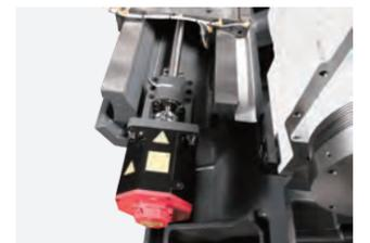
X/Z轴硬轨设计，可确保动态刚性并吸收震动，在重切削时保持良好精度。
