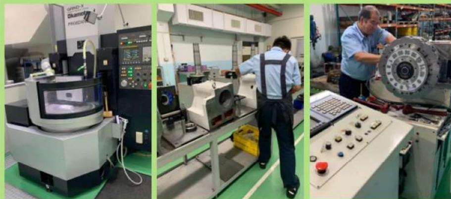
車床關鍵模組主軸台、動力刀塔
